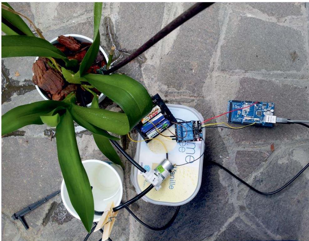
La scheda regola l'irrigazione e la luminosità ambientale sulla base di un programma preimpostato e in funzione del grado di umidità rilevato nel terreno. Dotando la scheda di una connessione a Internet, è possibile rilevare, da ogni luogo del mondo, le condizioni della pianta e impostare opportunamente (da PC, Tablet o Smartphone) i cicli di irrigazione e illuminazione.
